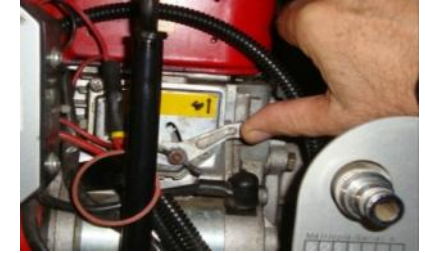
5 – Accendere e regolare l'acceleratore
