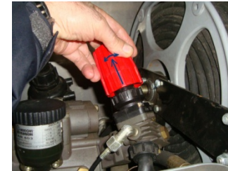
9 – Regolare la pressione: - Sollevare e girare il pomello Normalmente a 30-32 bar
