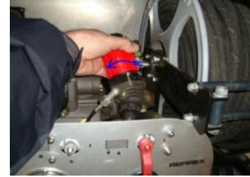
4 – By-pass aperto (avviare con pompa in scarico)
