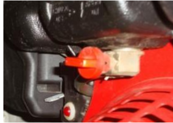
3 – Rubinetto benzina > verticale = aperto > orizzontale = chiuso
