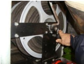
6 – Allentare il bloccaggio e svolgere il naspo
